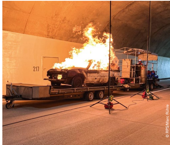
Brandschutzprüfung im Virngrundtunnel
